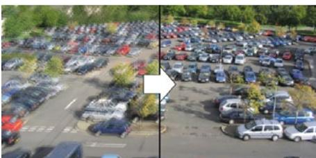
Ein digitaler Bildstabilisator gleicht kleine Verwacklungen aus, die zum Beispiel durch Wind bei einer Mastmontage auftreten können.
