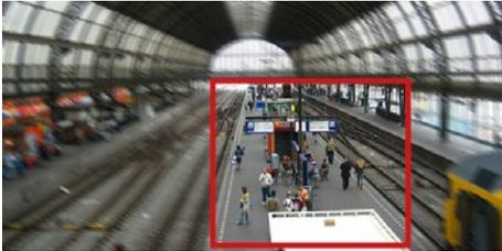
Unwichtige Bildbereiche können Sie mit reduzierter Qualität definieren. So sparen Sie Festplattenspeicher und Netzwerk-Bandbreite.
