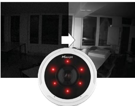
Bei schlechten Lichtbedingungen, zum Beispiel nachts, schaltet die Kamera automatisch in den Schwarz/Weiß-Betrieb um. Die Sicht wird zusätzlich durch die integrierte Infrarotbeleuchtung unterstützt. Die Kamera besitzt einen eingebauten Infrarot-Sperrfilter (IR-Cut-Filter). Damit werden störende Einflüsse der IR-Strahlung auf die Abbildungsqualität des Sensors vermieden.
